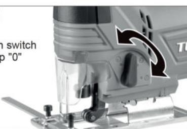
Selectia vitezei de batere(vezi Diagrama 6) Cu ajutorul rotilei mici, viteza de cursă necesară poate fi selectată (de asemenea, în timpul rulării).
